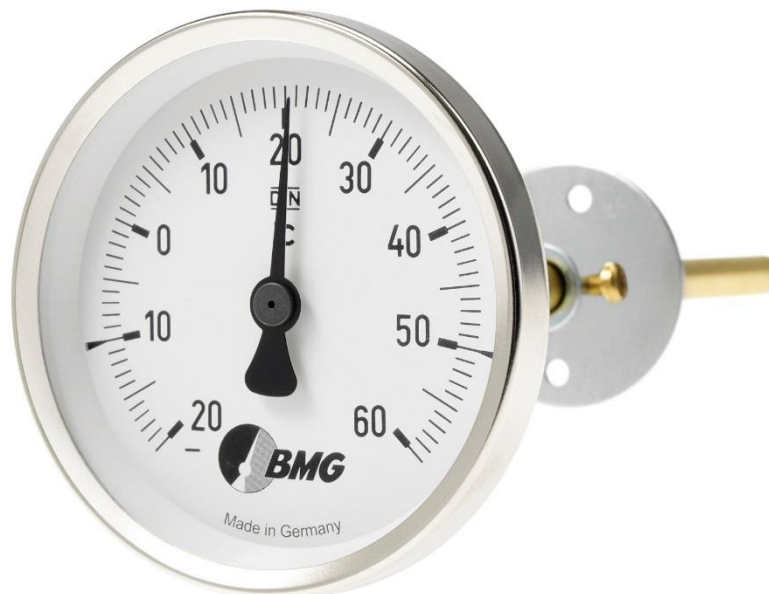
Luftkanalthermometer Typ T04, waagerechte Anschlusslage Tauchschaft Messing, verschiebbarer Flansch aus verzinktem Stahl, Ø 40 mm,
