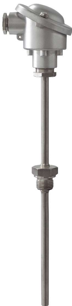
Typ 7630, Pt100 Einschraubfühler mit Kopf Form B mit Halsrohr 2-Leiter, Klasse B festes Einschraubgewinde Edelstahl G1/2
