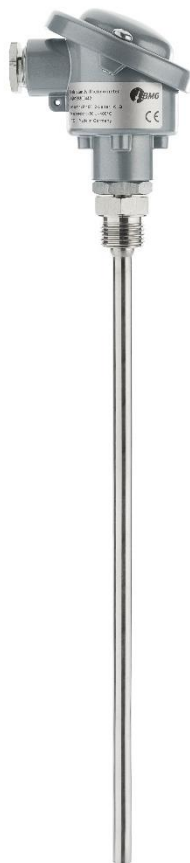
Typ 7620, Pt100 Einschraubfühler mit Kopf Form B ohne Halsrohr 2-Leiter, Klasse B festes Einschraubgewinde Edelstahl G1/2
