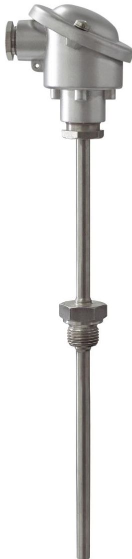
Widerstandsthermometer mit Anschlusskopf Form B, Sensor Pt-100, mit Halsrohr, Tauchschaft und Einschraubgewinde G1/2 in Edelstahl 1.4571
