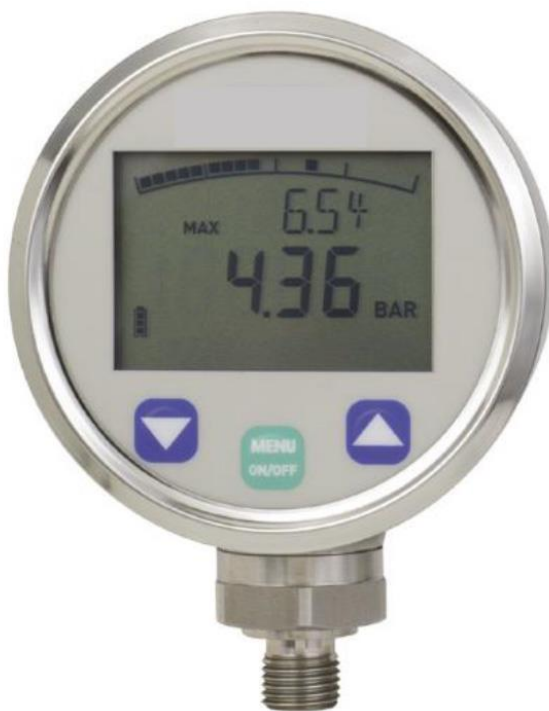
Digitalmanometer Typ 7074 mit einstellbarer Abschaltzeit Druckanschluss: um 300° drehbar, Gewinde G1/2 4½-stellige LCD-Anzeige, mit Beleuchtung
