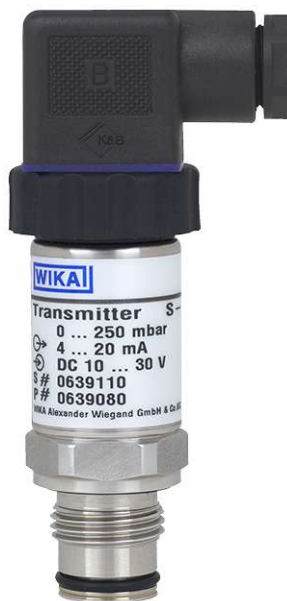
Typ 7032 (WIKA-Sensor S-11) mit frontbündiger Membran Druckmessumformer Einschraubgewinde Gehäuse und Druckeranschluss Edelstahl Winkelstecker nach DIN EN 175301-803
