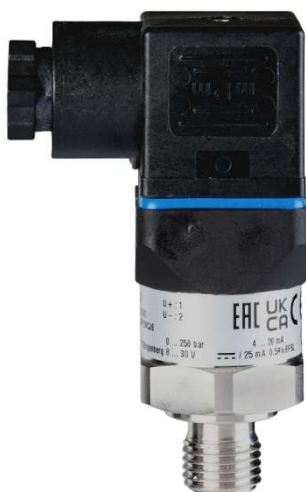
Druckmessumformer Typ 7018 (WIK-Sensor A-10) Gehäuse und Druckeranschluss Edelstahl Mit Dichtung für Gegenstecker, Dichtung NBR Einschraubgewinde G1/4 A DIN EN ISO 1179-2 (ehemals DIN 3852-E), Elektrischer Anschluss: Winkelstecker nach DIN EN 175301-803, Form A mit Kabeldose
