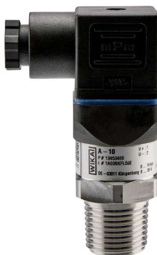
Druckmessumformer Typ 7018 (WIK-Sensor A-10) Gehäuse und Druckeranschluss Edelstahl Mit Dichtung für Gegenstecker, Dichtung NBR Besonderheit: Einschraubgewinde R 1/2 - ISO7 (DIN2999), Elektrischer Anschluss: Winkelstecker nach DIN EN 175301- 803, Form A mit Kabeldose
