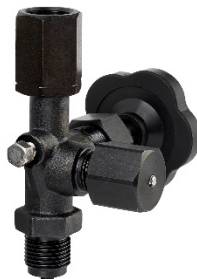
Absperrventil 5931-DVGW Ausführung Gehäuse Stahl Spannmuffe und Überwurfmutter aus Stahl Prüfanschluss M20x1,5
