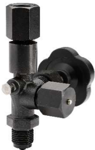
5931-B – Gehäuse Stahl Spannmuffe Stahl Überwurfmutter Stahl Prüfanschluss M20x1,5 Ausführung mit Steg für Messgerätehalter
