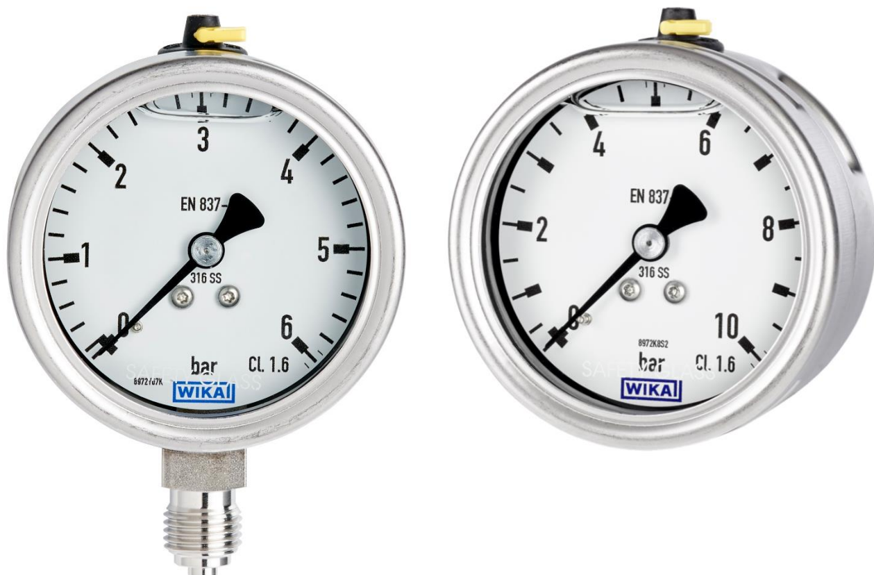
Typ 5491 mit Glycerinfüllung, NG 63 mm, Rohrfedermanometer mit Bajonettring, komplett aus Edelstahl Anschluss senkrecht, G1/4B Anschluss rückseitig, G1/4B
