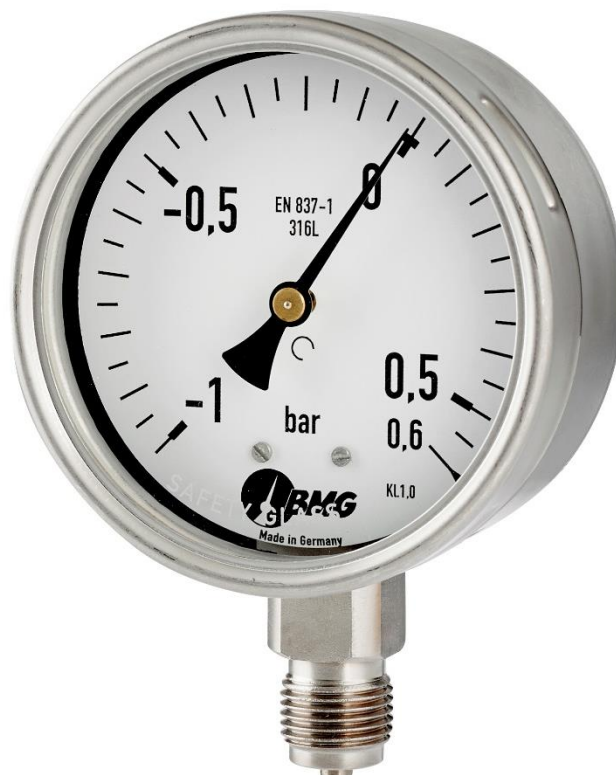
Typ 5480 Rohrfedermanometer mit Bajonetting, komplett aus Edelstahl NG 100 mm, Anschluss senkrecht, G1/2B
