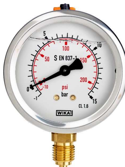
Rohrfedermanometer Grundtyp 5400 Edelstahlgehäuse mit Messinganschluss, ECO-Ausführung, Firmenzeichen WIKAI, G1/4B NG Ø 63 mm, Glycerinfüllung WIKAI Typ 213.53 Dieses Gerät hat als Sicherheitsfunktion eine Entlastungsöffnung. Im Fehlerfall kann dort der Überdruck entweichen.
