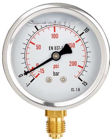
Rohrfedermanometer Grundtyp 5400 Edelstahlgehäuse mit Messinganschluss, ECO-Ausführung, ohne Firmenzeichen, G1/4B NG Ø 63 mm, Glycerinfüllung
