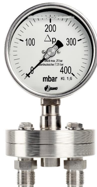
Abbildung zeigt Plattenfeder-Differenzdruckmanometer mit Glycerinfüllung, Anschlusszapfen nebeneinander
