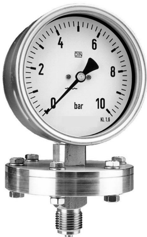
Plattenfedermanometer 5290 Gehäuse Edelstahl NG 100 mm, Bajonetting Oberer Messflansch und Einschraubgewinde Stahl, verzinkt
