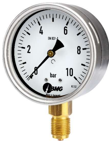
Rohrfedermanometer Grundtyp 5190 Bild zeigt Anzeigebereich 0...10 bar Edelstahlgehäuse mit Messinganschluss, G1/2B NG Ø 100 mm
