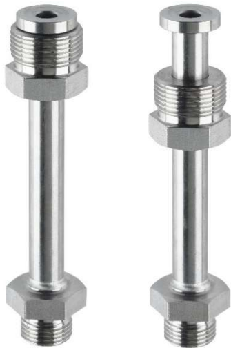
Halsrohr nach DIN 43772 Abbildung: Werkstoff Edelstahl 1.4571 Gesamtlänge L = 105 mm Lose Verschraubung M24x1,5 Gewinde M18x1,5 außen
