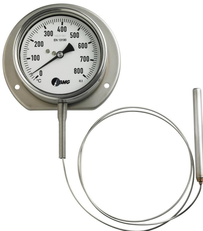
Gasdruckthermometer Typ 34 Edelstahlgehäuse mit Bajonetting, hinterer Befestigungsrand Standard: 1-m-Kapillarleitung mit Fühler (Ø 10 x 100 mm) aus Edelstahl
