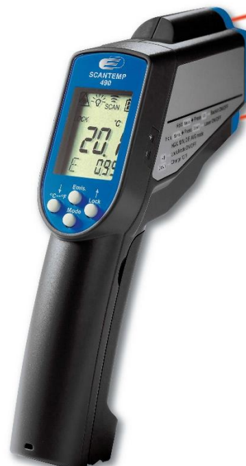
Infrarot-Handmessgerät Typ 250311123k Emissionsgrad einstellbar Mit Dual-Laser, D:S =50:1 Messbereich -60...+1000°C HACCP-konform
