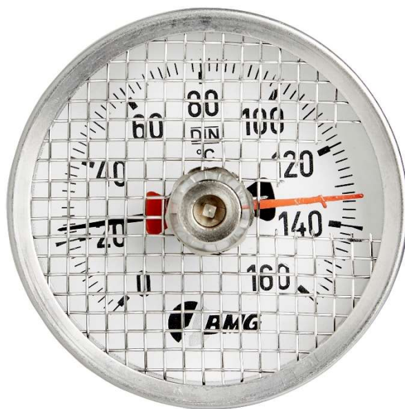
Thermometer mit Schleppzeiger Nenngröße 63 mm, Edelstahlgehäuse Drahtgeflecht, statt Sichtscheibe aus Glas Option: Drahtausschnitt von 120° bis 140°C
