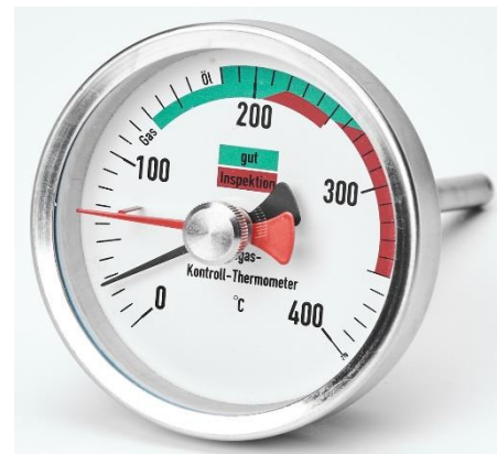
Typ 1831schmagnet Einsteck-Tauchschaft Edelstahl, 100 mm x Ø 6 mm Abgasthermometer, Kontrollthermometer mit rotem und grünem Farbfeld
