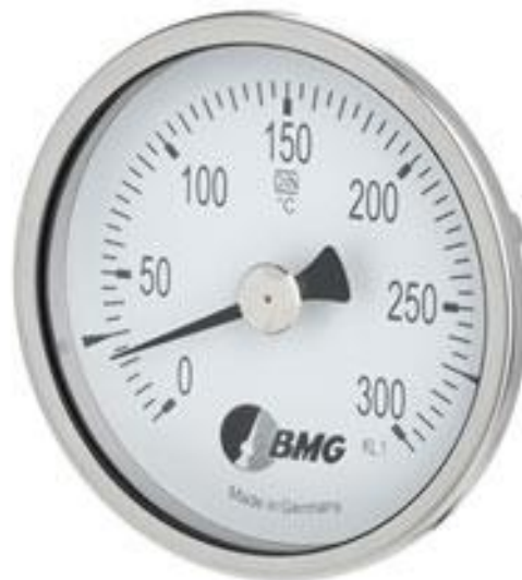
Backofenthermometer Typ 1261, Nenngröße 80 mm Edelstahl-Bördelringgehäuse, wasserdicht IP65 Tauchschaft aus Edelstahl, Anschluss: loses Gewindestück G1/2, Messing
