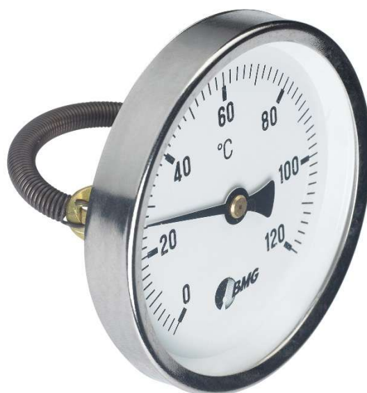
Rohr-Anlegethermometer, verzinkter Stahl, z.B. zur Messung der Vor- und Rücklauftemperaturen an Heizungen, Befestigung mittels Feder
