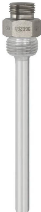
Schutzrohr nach DIN 43 772 Form 8 zum Einschrauben Schutzrohr mit beiderseits Außengewinde, G1/2 für Temperaturmessgeräte mit Innengewinde Abbildung: Werkstoff Edelstahl
